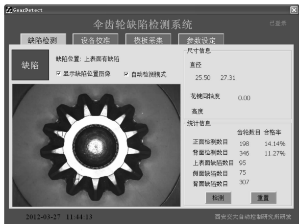
图6 伞齿轮上表面有缺陷的检测结果
